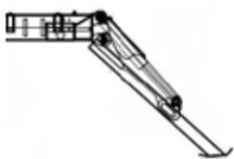
Независимые стабилизирующие опоры позволяют устанавливать балку стабилизатора вне зависимости от положения крана.
